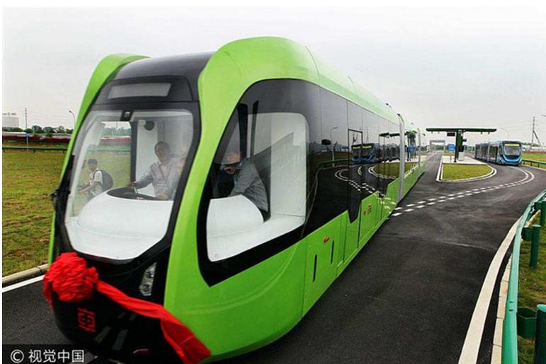
Figura 16: Art ( Autonomous rapid transit), il primo tram al mondo a viaggiare senza conducente fonte: <https://www.lettera43.it/>
